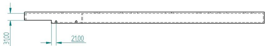
REALICE UN CORTE A 16 mm DEL SEGUNDO AGUJERO Y SUELDE EL TOPE [TP-CA501](#) PROVISTO EN EL KIT COMO SE VE EN LA IMEGEN
